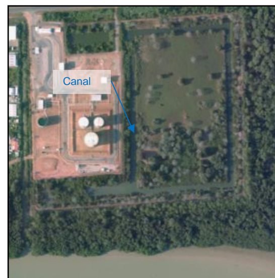
Figure 37 : Réseau de drainage du site étudié, formé par un canal
